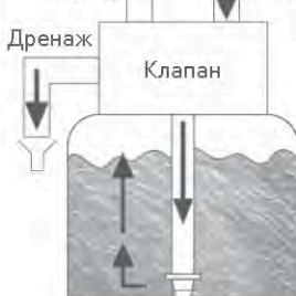
С1 ОБРАТНАЯ ПРОМЫВКА Выход Вход
