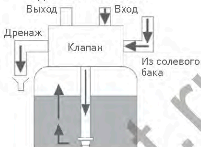
С1 ПОДАЧА СОЛЕВОГО РАСТВОРА И МЕДЛЕННАЯ ПРОМЫВКА
